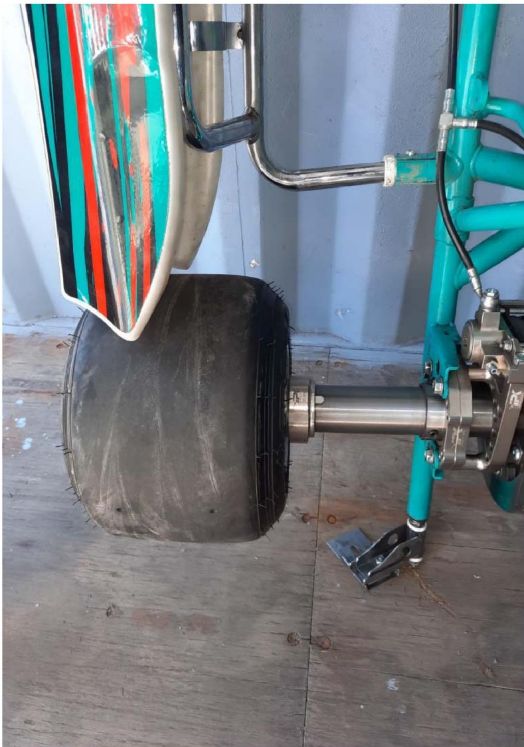
Φωτογραφία 1.5. Πίσω αριστερά τροχός οχήματος Α. Δεν παρατηρείται μεταβολή γεωμετρίας άξονα. Πηγή: Αυτοψία των πραγματογνωμόνων στις εγκαταστάσεις της Speed Park στις 3/10/2021.
